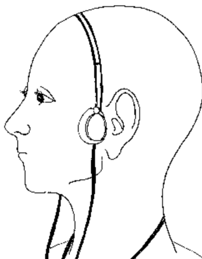
Рисунок 3. Схема расположения звукоуловителей
