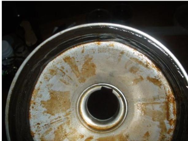
Рисунок 4.5 – Осадок суспензии в грязевой полости молочного сепаратора
