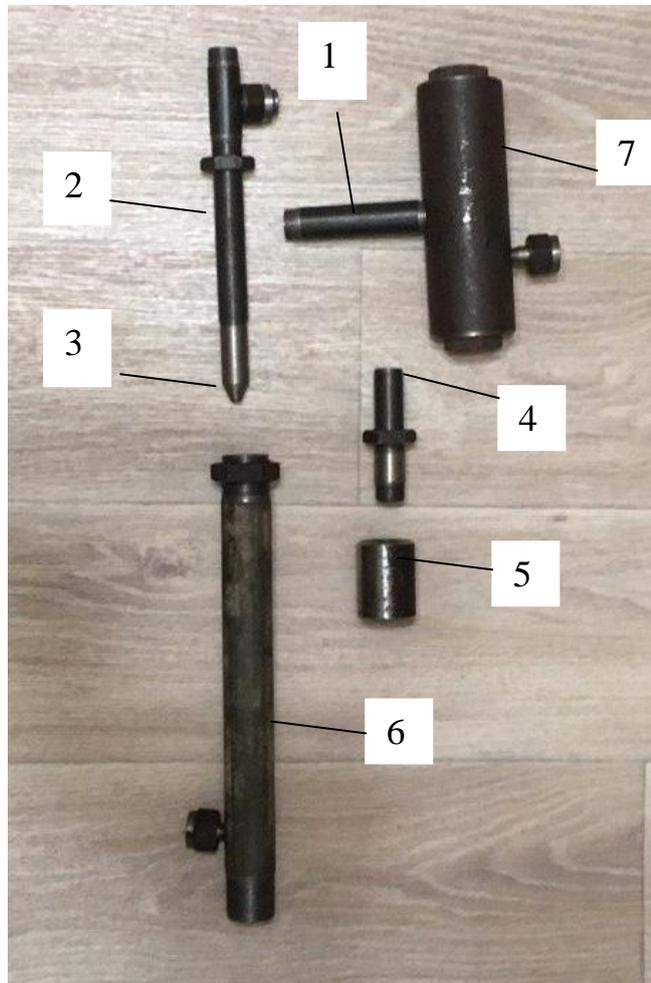
1 – подвод потока полезной подачи; 2 – подвод рабочего потока, 3 – рабочее сопло; 4 – входное сопло камеры смешения; 5 – муфта;
