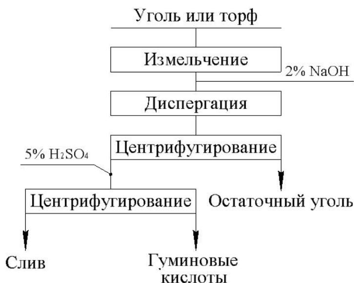
Рисунок 1.3 – Технологическая схема получения гуминовых кислот диспергационным способом по Волкову
