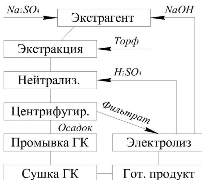
Рисунок 1.5 – Схема производства гуминовой кислоты с совместным высаждением кислот и электрохимической регенерацией основных реагентов
