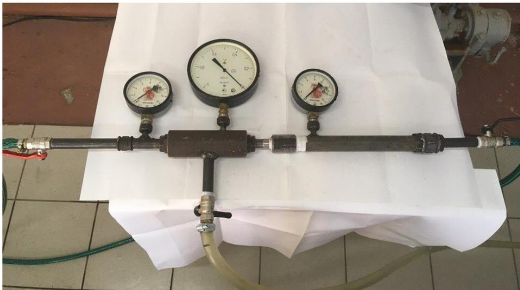
Рисунок 3.5 – Эжектор в составе лабораторной установки
